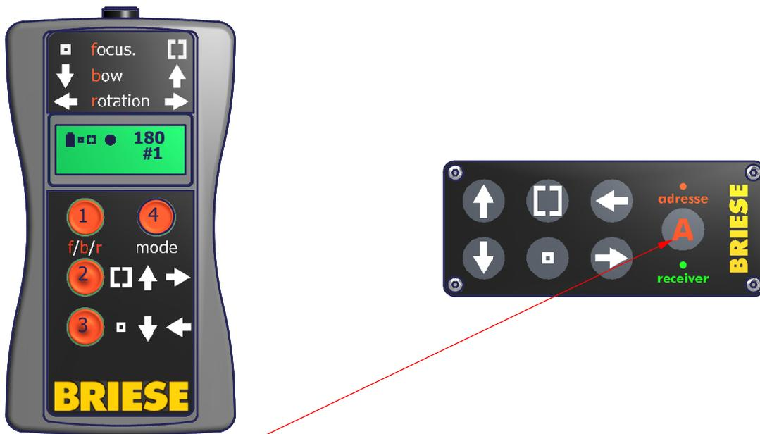
An dem E - Focus das **A** für Adresse betätigen, dann die gewünschte Adresse sowie Funkfrequenz an der Fernbedienung einstellen und zuletzt die "**LEARN**" - Funktion mit der Taste **3** auslösen.
